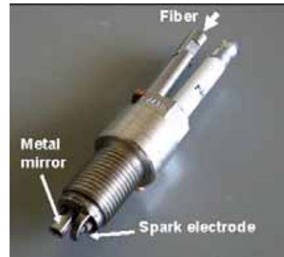
図 2 点火栓埋め込み型センサ部
